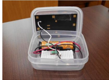
光を電気に変える太陽電池を使って、簡単な電子回路を組み立てます。太陽光で作った電気を貯め、暗くなると自動で明かりが灯るソーラーキャンドルをつくろう
